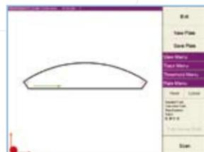
Для облегчения использования в агрессивной среде резервуара в ударопрочном встроенном компьютере применена технология сенсорного экрана. Специально разработанное программное обеспечение для считывания данных не только считывает сигналы магнитного рассеянного потока, но и анализирует их, выводя на экран месторасположение и степень коррозии в режиме реального времени.
